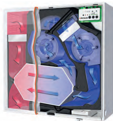
Abb. 1: Funktionsschema ERG 60, auch für Version Unterputz
