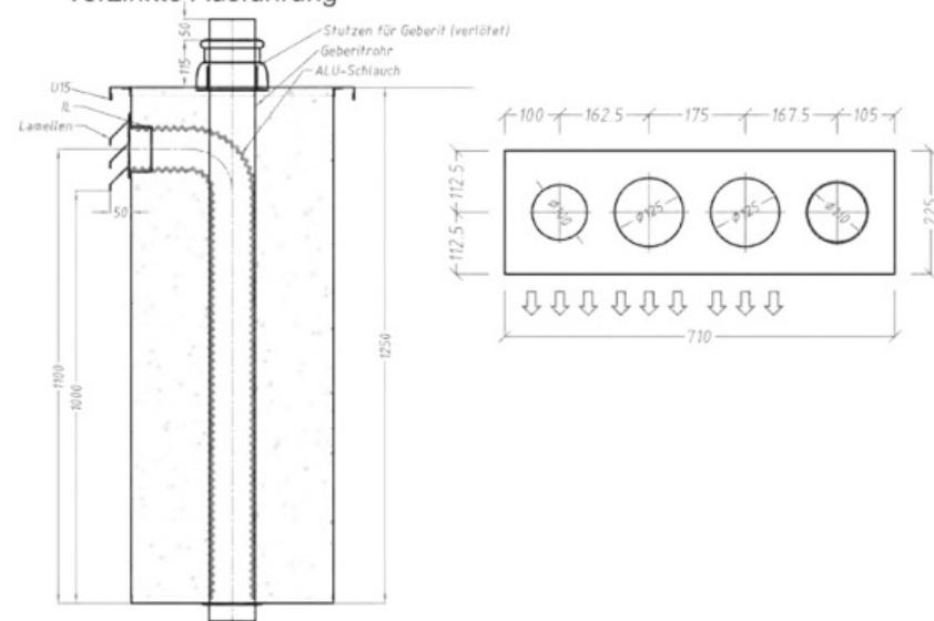
**Ausführung in Color-Blech, lackiert in RAL nach Wahl bzw. mit Sonderanschlüssen oder Sonderabmessungen auf Anfrage.**
