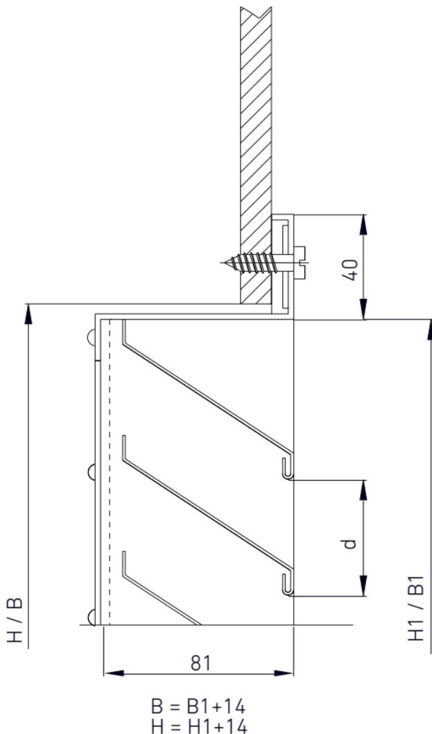
Befestigung mittels Schrauben direkt am Kanal.
