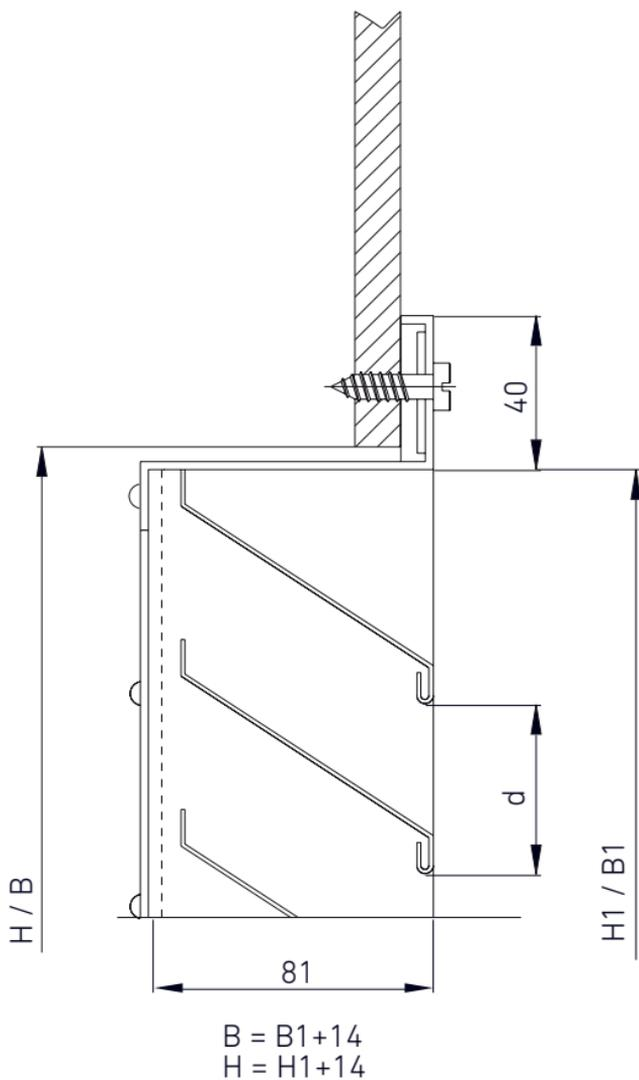
Befestigung des Wetterschutzgitters mittels Schrauben am Kanal.
