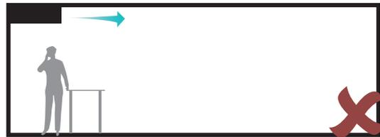
2. In einem Raum mit hoher oder schräger Decke sollten die Geräte so hoch wie möglich montiert werden.
