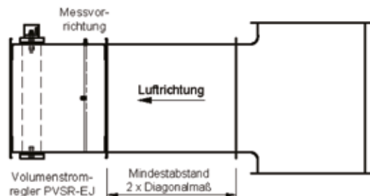
Anströmstrecke nach Formstück (Abzweiger, Reduktion etc. ...)
