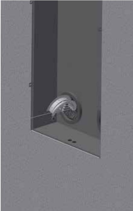
Kunststoffgitter NW170 durch Öffnung führen
