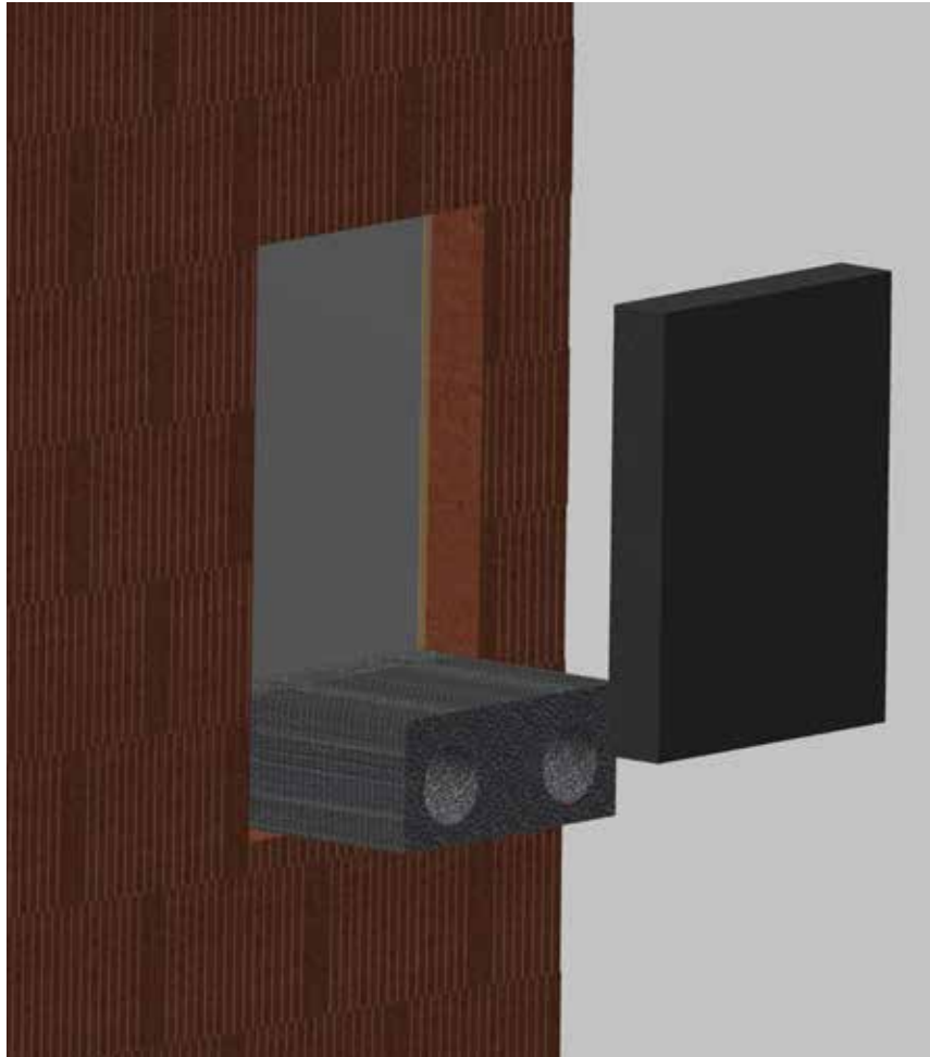
Ausgleichsdämmung mit WDVS-Klebschaum ankleben
