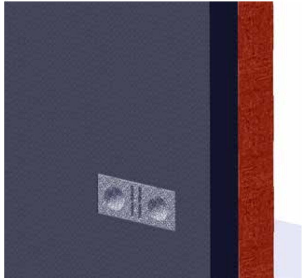
Wanddurchführung bündig mit Fassadendämmung
